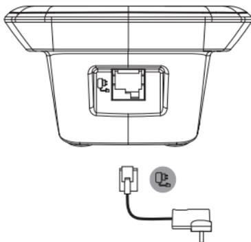
1. 將帶有連接插頭的充電器接上充電座後方
